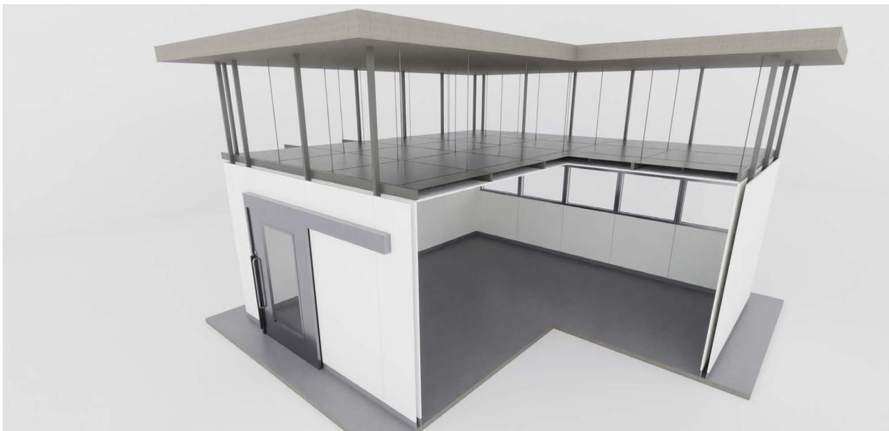
Die Unterkonstruktion besteht aus einem Verbund von Längs- und Querprofilen, sowie einem umlaufenden Randprofil. Die Begehpaneele können sowohl von unten als auch von oben in den Deckenrost eingelegt werden. Die Konstruktion der Begehpaneele erlaubt eine schnelle De- und Wiedermontage. Die
